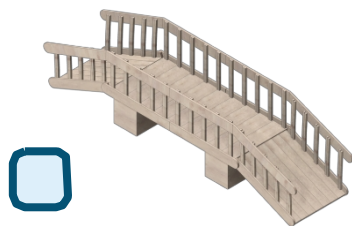
Ponte a travi
